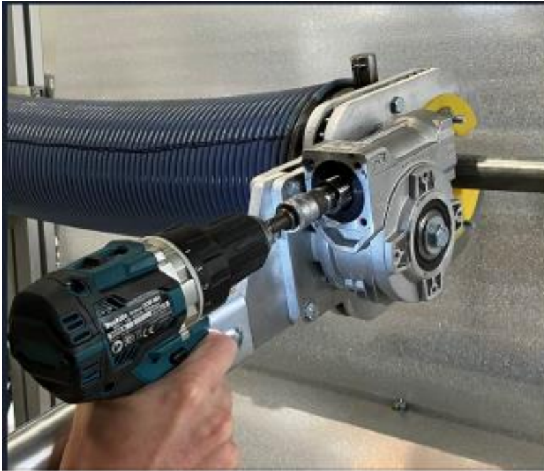
Figure 2 Application de l'Industrial torQtool 2 à l'aide d'une perceuse : le ressort est tendu par l'entraînement de la mèche et non par une force manuelle.
