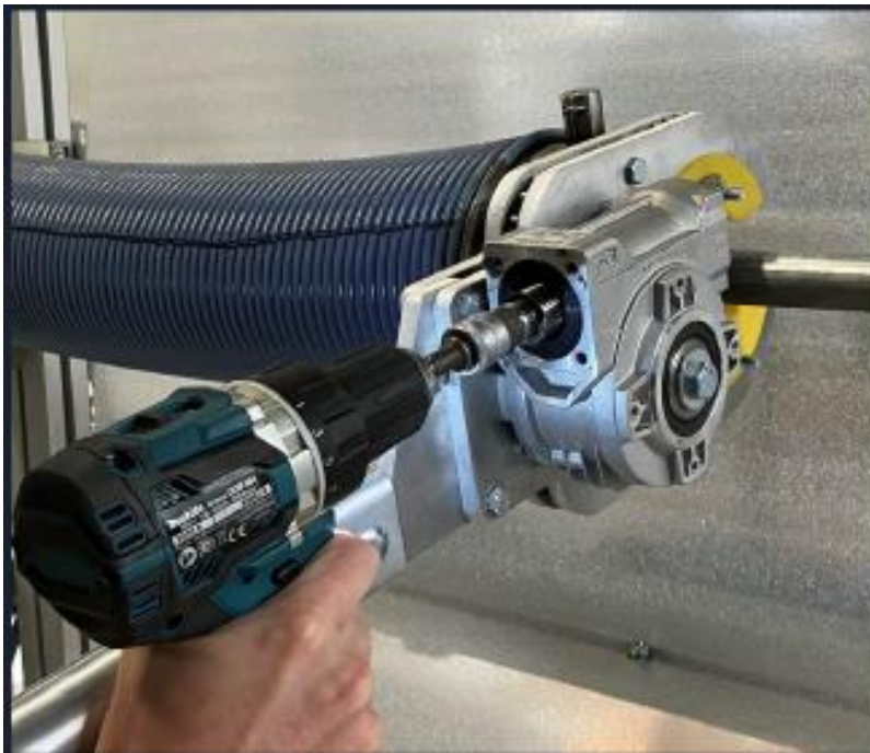
Abbildung 2 Anwendung des Industrial torQtool 2 mit Hilfe einer Bohrmaschine: Die Feder wird durch den Antrieb des Bohrers und nicht durch Handkraft gespannt.
