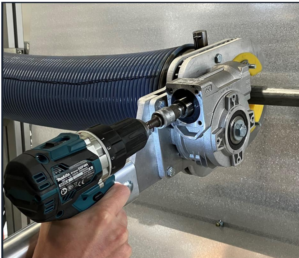
Figuur 2 Toepassing Industrial torQtool 2 met boortol: de veer wordt opgespannen door de boortol aandrijving en niet met handkracht.
