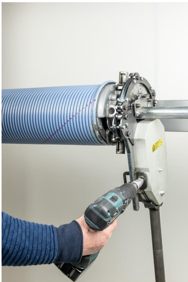
Figuur 2 Toepassing Industrial Torqtool met boortol: de veer wordt opgespannen door de boortol aandrijving en niet met handkracht..
